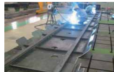
▲プラント用部材の溶接
