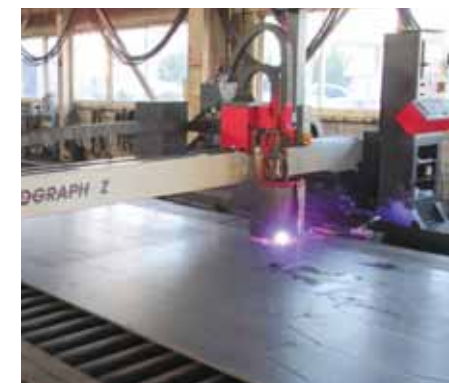
▲プラズマ切断機
