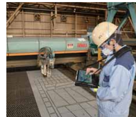
▲データトラッキング (切断機オペレーター)
