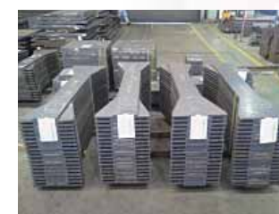
溶断製品（ガス切断）
