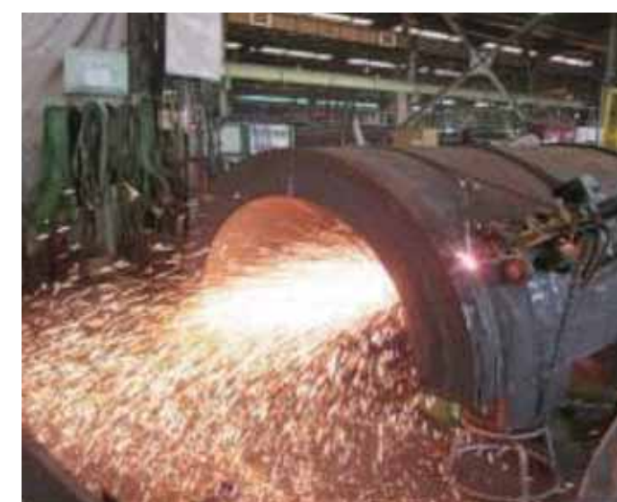
▲円筒形曲げ板の円周溶断状況
