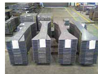
溶断製品（ガス切断）
