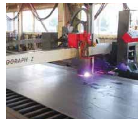
▲プラズマ切断機
